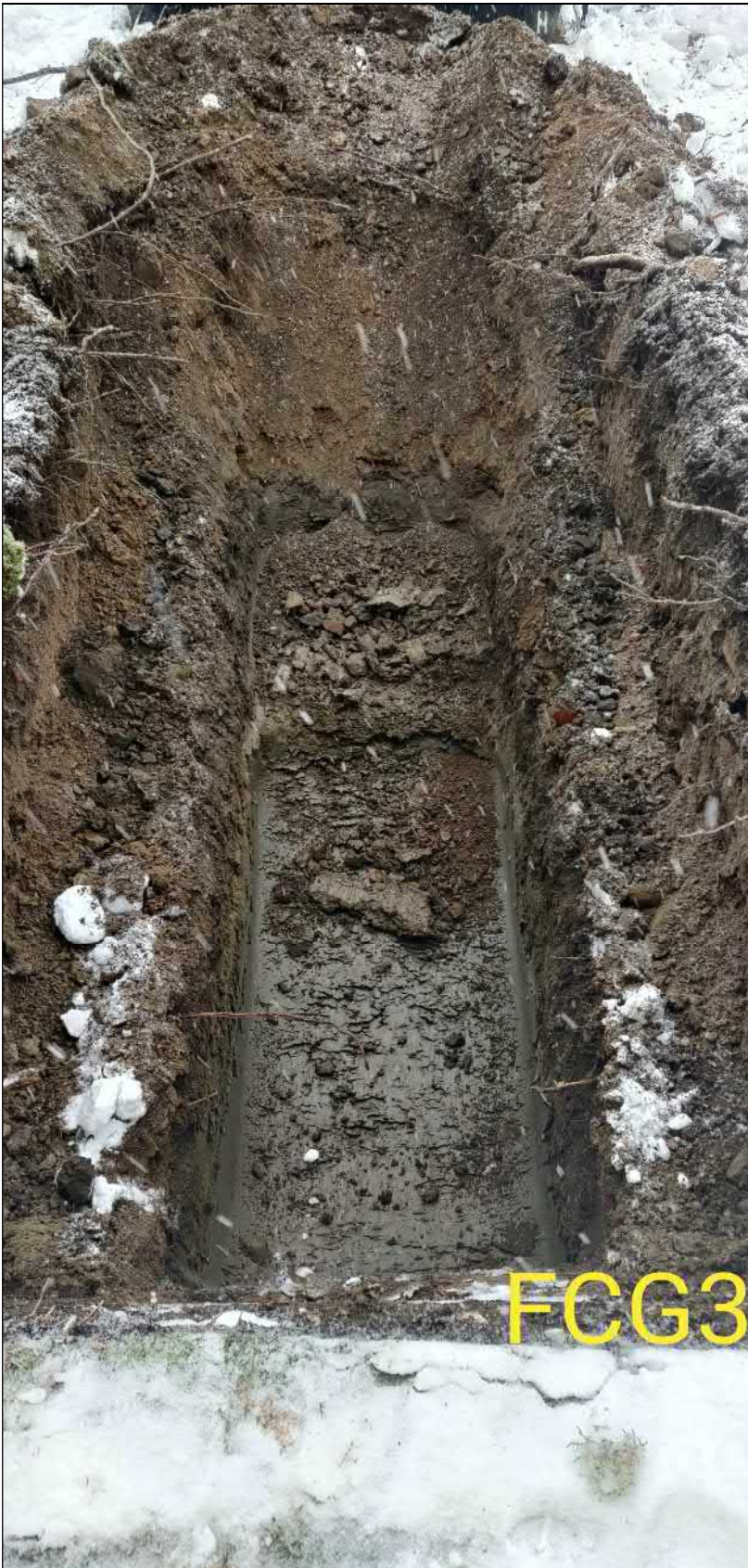
Kuva 4. Pohjamaa savi todettiin tutkimuspisteessä FCG3, syvyydellä 1,5 m alkaen, näytesyvyys 1,5-2,0 m. Kallion pintaa ei todettu.
