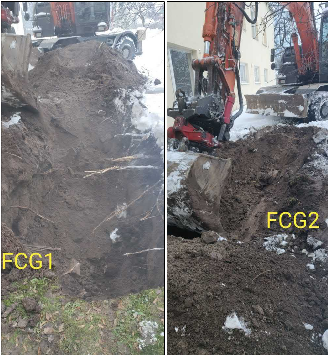
Kuva 3. Tutkimuspisteet FCG1 ja FCG2. Maakerrokset pinnan humus/nurmikerroksen alapuolella sisälsivät tutkimuspisteissä hienoa hiekkaa ja silttiä 2-2,5 m asti. Tutkimuspisteestä FCG1 näyte otettiin hiekkaa ja silttiä sisältävästä täyttömaakerroksesta, 0,5-2,2 m syvyydeltä. Tutkimuspisteestä FCG2 näyte otettiin kaivumontun pohjaosan hiekkakerroksesta, syvyydeltä 2-2,5 m. Tutkimusteissa todettiin hiekkamaakerroksessa yksittäisiä jätejakeita (muovin ja tiilen palat).
