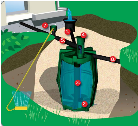
Bild 5. Exempel på ett uppsamlingssystem för regnvatten där dagvattenbrunnen består av en 1600 liters tank. Noggrannare information finns i tillverkarens broschyr Meltex-Herkules-tank.
