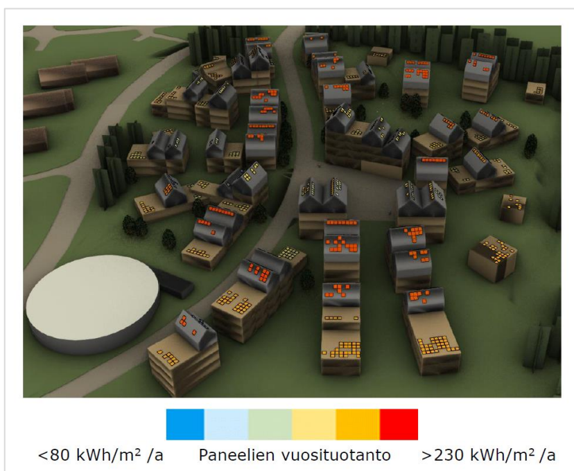
Bild 10. Solpanelernas årliga produktion varierar beroende på luftriktning och installationsvinkel (Ramboll, 2022).
