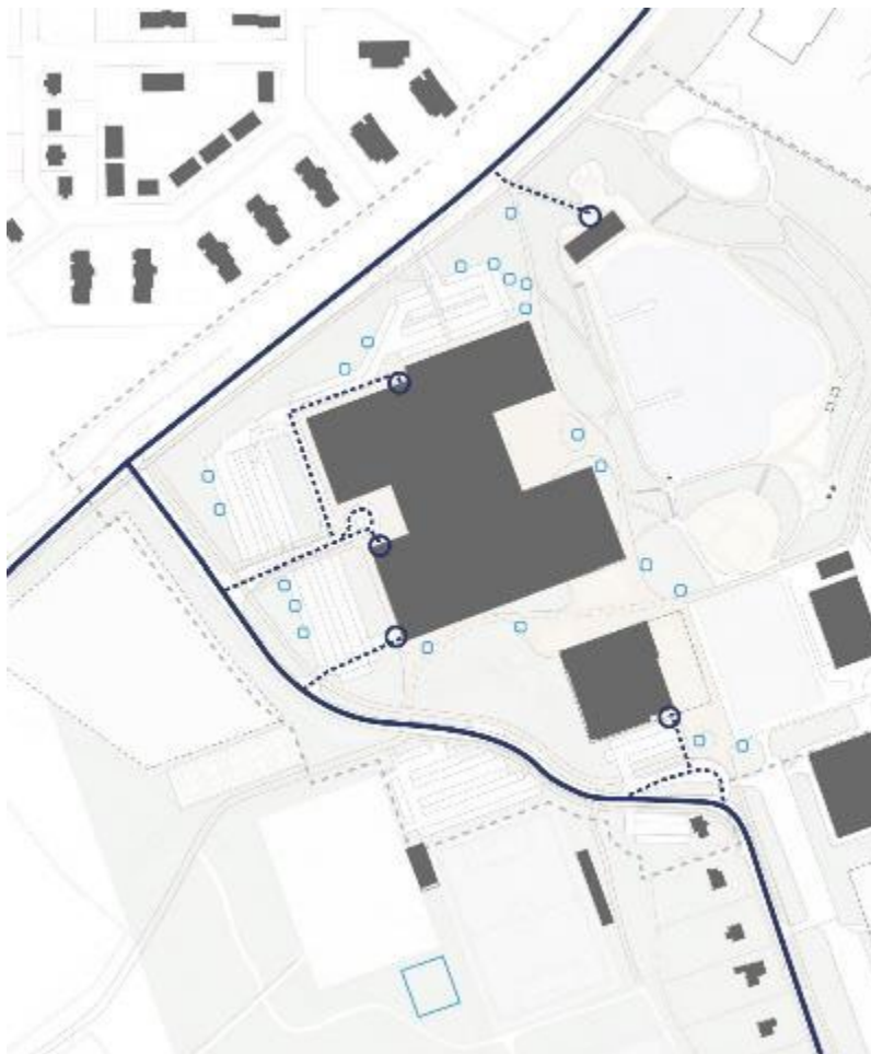
Kuva 33. Huoltoreitit ja lumitilojen periaatteelliset sijainnit (MASU Planning).
