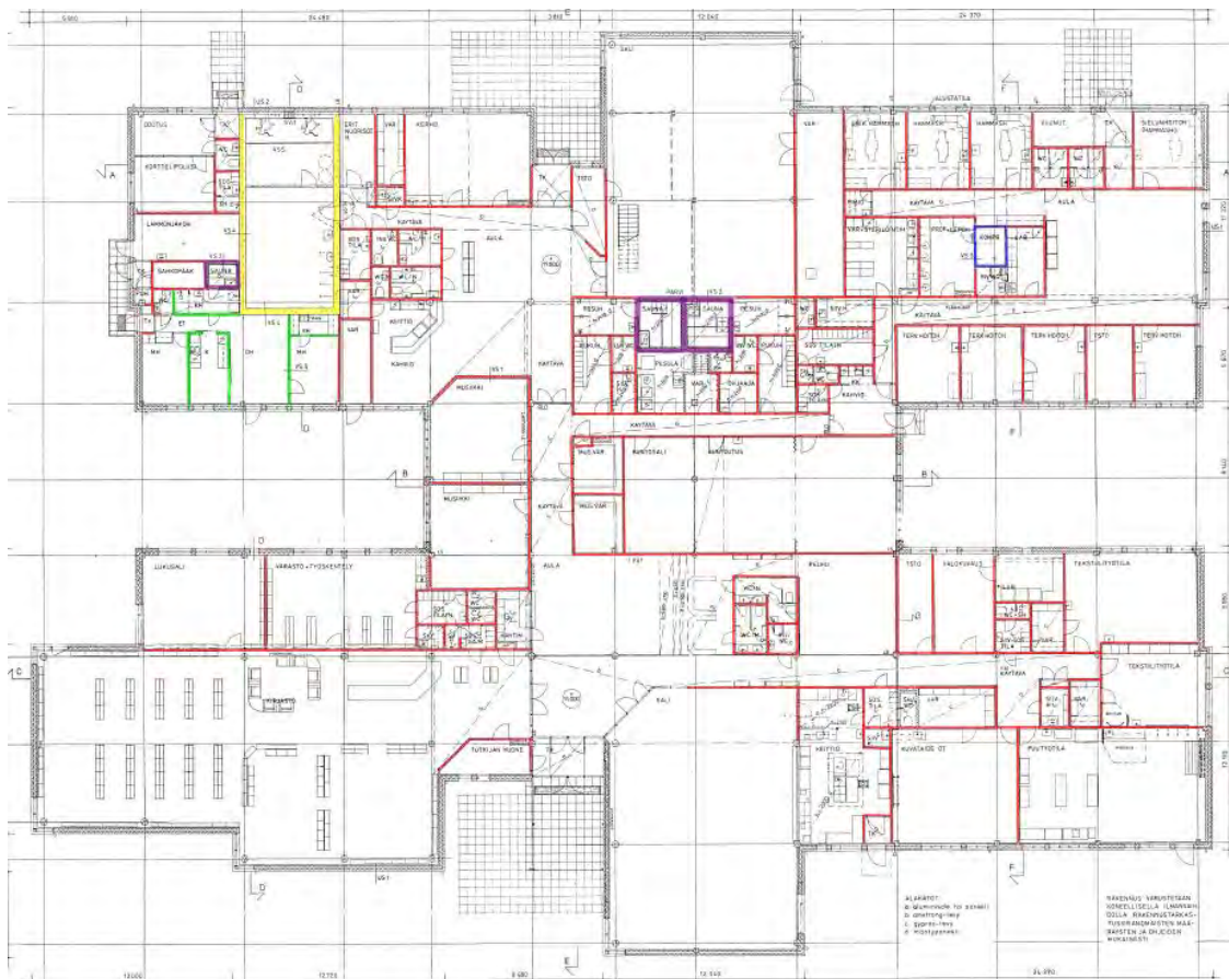
Kuva 55. Väliseinärakenteiden päärakennettyyppi tiiliväliseinä VS1 on merkattu punaisella värillä, saunojen väliseinärakenteiden rakennettyyppi VS2 on merkattu violetilla värillä, äänieristetty tiilirakenne VS3 on merkattu sinisellä värillä, väestösuojaan teräsbetoniset väliseinät VS4 on merkattu keltaisella värillä ja kipsilevyväliseinät VS5 on merkattu vihreällä värillä.
