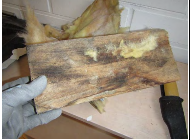
Kuva 27. Rimat oli olivat tummuneet ja pehmentyneet.
