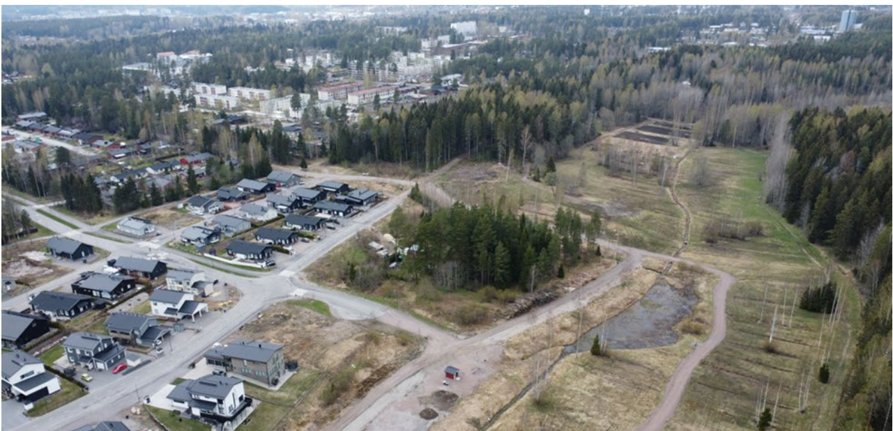
Kuva 1: Kopterikuva etelästä päin. Kevätlaaksosta on osa jo rakennettu ja osa vasta kaavoitettu. Laakson valtaojan varteen on muotoiltu hulevesitulvia tasaava lampi. Kevätlaaksonrinne sijoittuu laakson pohjoispäähän, joka näkyy kuvan oikeassa yläkulmassa sekametsänä.
