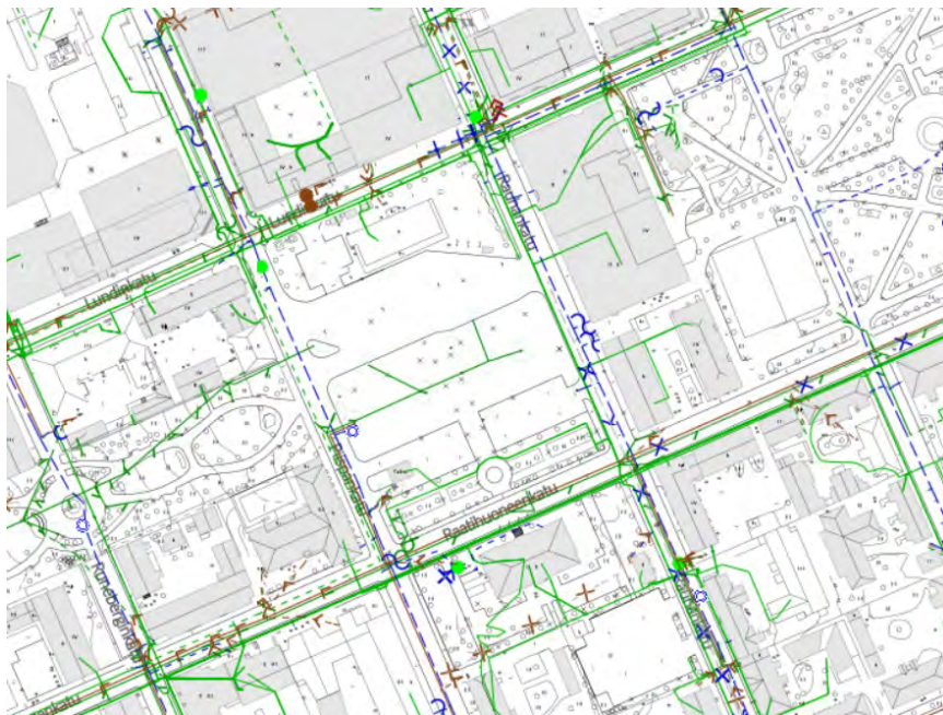
Nätverk av elledningar, vattenförsörjning, datakommunikationer och gatubelysning vid torget och på närliggande gator. (2020)
