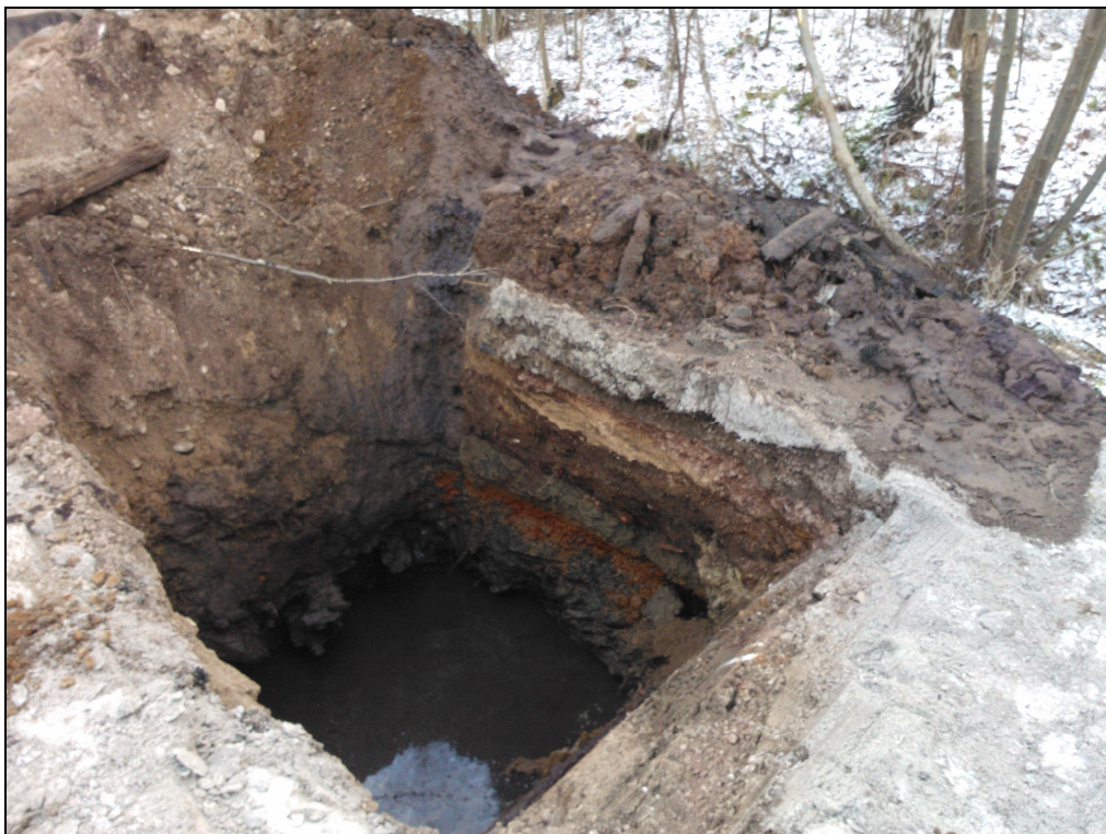
Kuva 2. Koekuoppa KK2. Kuopan seinämässä näkyvissä eri täyttökerroksia. Kuopasta löydettiin lisäksi isompia puun kappaleita mm. pölkkyjä.
