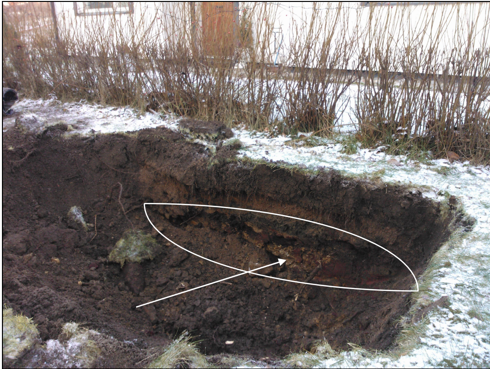
Kuva 3. Kiinteistöjen rajalle tehty koekuoppa KK3. Punertava kuonatäyttö alkaa 0,5 m syvyydessä maanpinnasta, kuonakerroksen paksuus noin 0,6 m.
