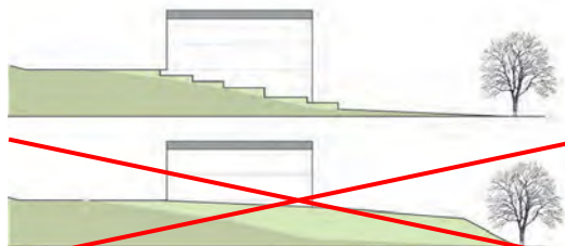
Kuva 3. Tasoerot tulee ratkaista luonnollista maanpintaa myötäilevillä luiskilla tai terassoimalla piha tukimuurien avulla. Korkeat pengerrykset eivät ole sallittuja.
